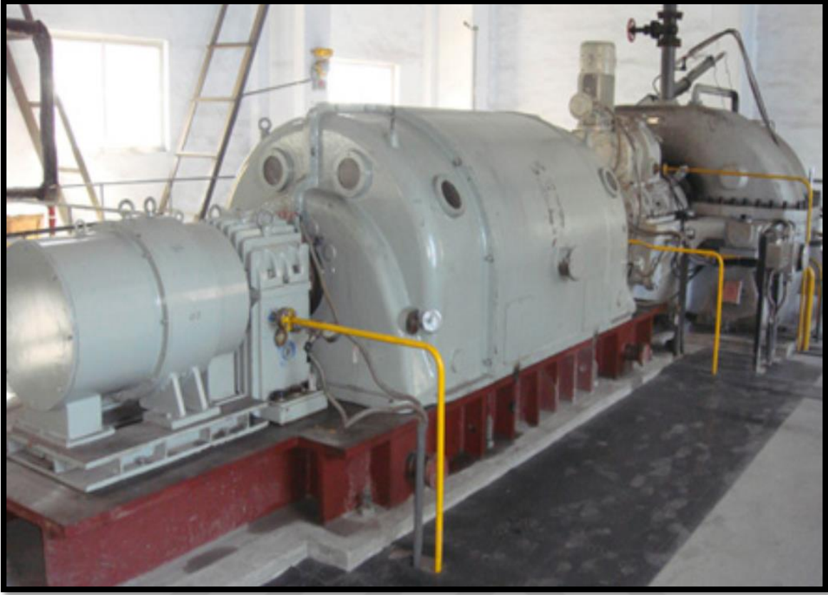
Şekil 2.6. Tepe basıncı geri kazanım türbini (SINOSTEEL, 2019)
