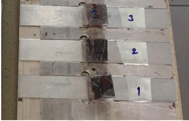
Resim 3.11. Yapıştırıcı uygulanan kalıp içerisindeki metal-metal numuneleri
