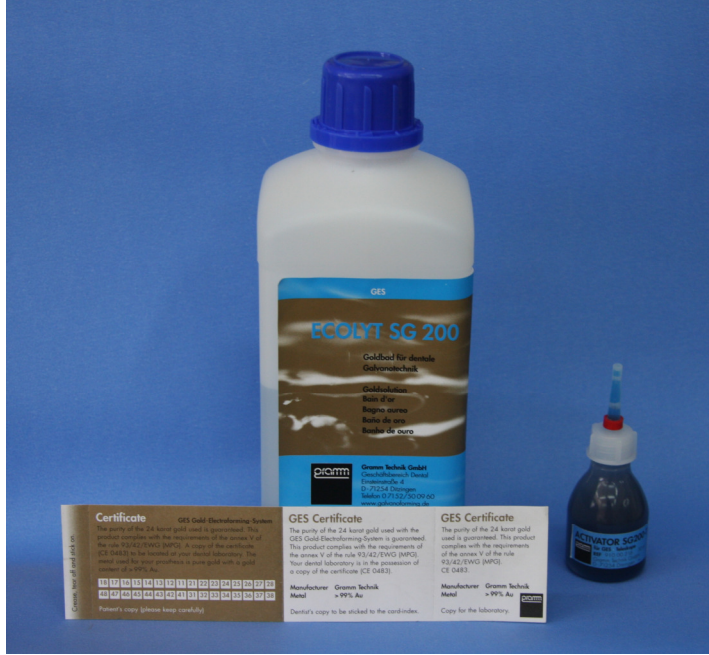
Şekil 3-20: Kullanılan elektroşekillendirme sıvısı ve aktivatörü.
