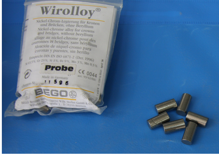
Şekil 3-42: ZC grubu sekonder kuronlarının üretiminde kullanılan döküm krom alaşımı.
