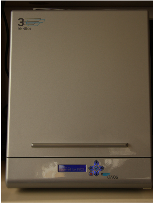
Şekil 3-24: CAD-CAM sisteminin tarayıcı ünitesi.
