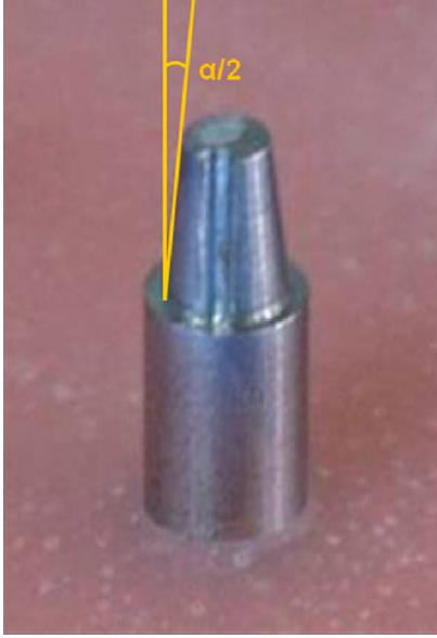
Şekil 3-1: Farklı açılara sahip dayanak maketleri ve açılmış oluğun görünümü.
