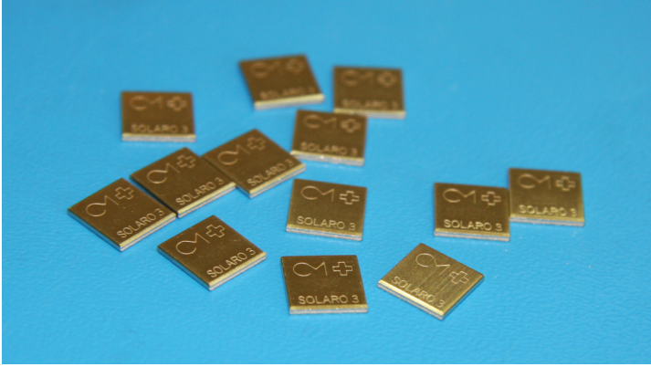
Şekil 3-4: Primer kuronların döküldüğü Solaro 3 altın alaşımı.
