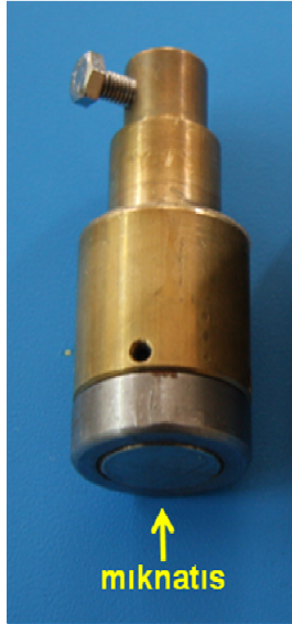
řekil 3-46: Dayanak maketinin yũk hũcresine baĐlanmasını saĐlayan mıknatıslı dũzenek.
