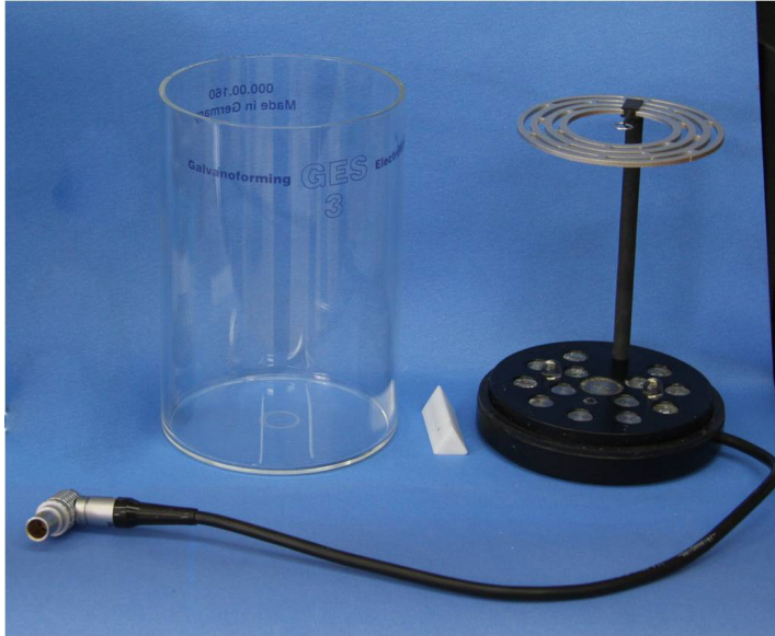
Şekil 3-21: Elektroşekillendirme işleminde kullanılan cihaz parçaları.
