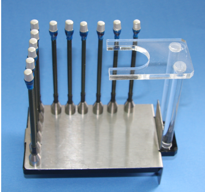
Şekil 3-19: Altın ile kaplanması istenmeyen bölgeleri sistemin özel mumu ile kapatılmış elektroşekillendirme hazır örnekler.
