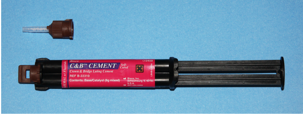
Şekil 3-44: Örneklerin yapıştırılmasında kullanılan reçine siman.
