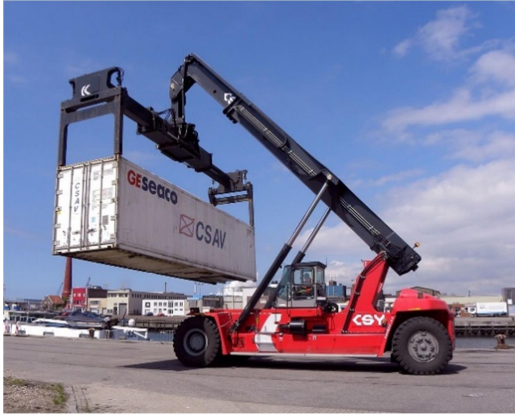
Resim 2. Reach Stacker ve Forklift
