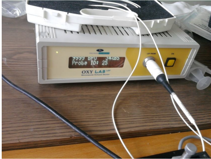
Şekil 3.4: Doppler cihazı ve probu(kalibre haldeyken)
