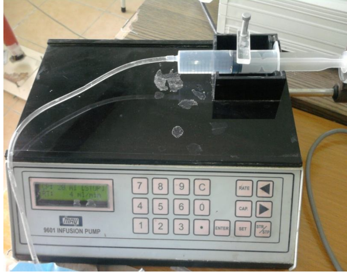
Şekil 3.8: Kolonik basınç ölçümü için infüzyon pompası
