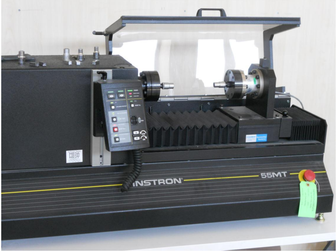
Şekil 3.14: Instron 55MT2 düşük kapasiteli burma test sistemi
