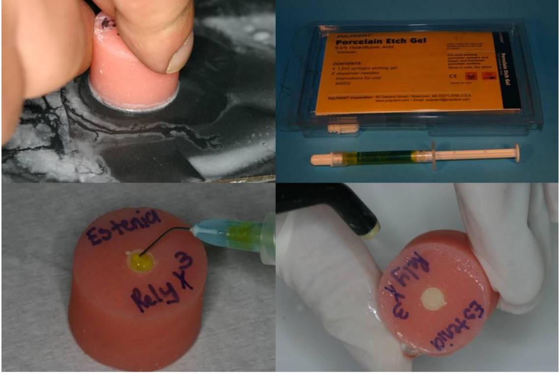
Şekil 3-10: %9,6'lık Hidrofluorik asit ile yüzey hazırlama
