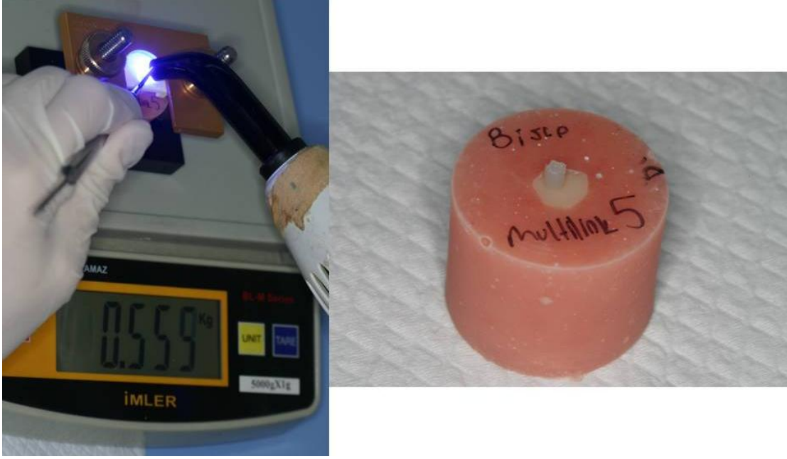
Şekil 3-18: Basınç altında 20 sn ışıkla polimerize olduktan sonra ultradent apereyinden çıkan deney örneği.
