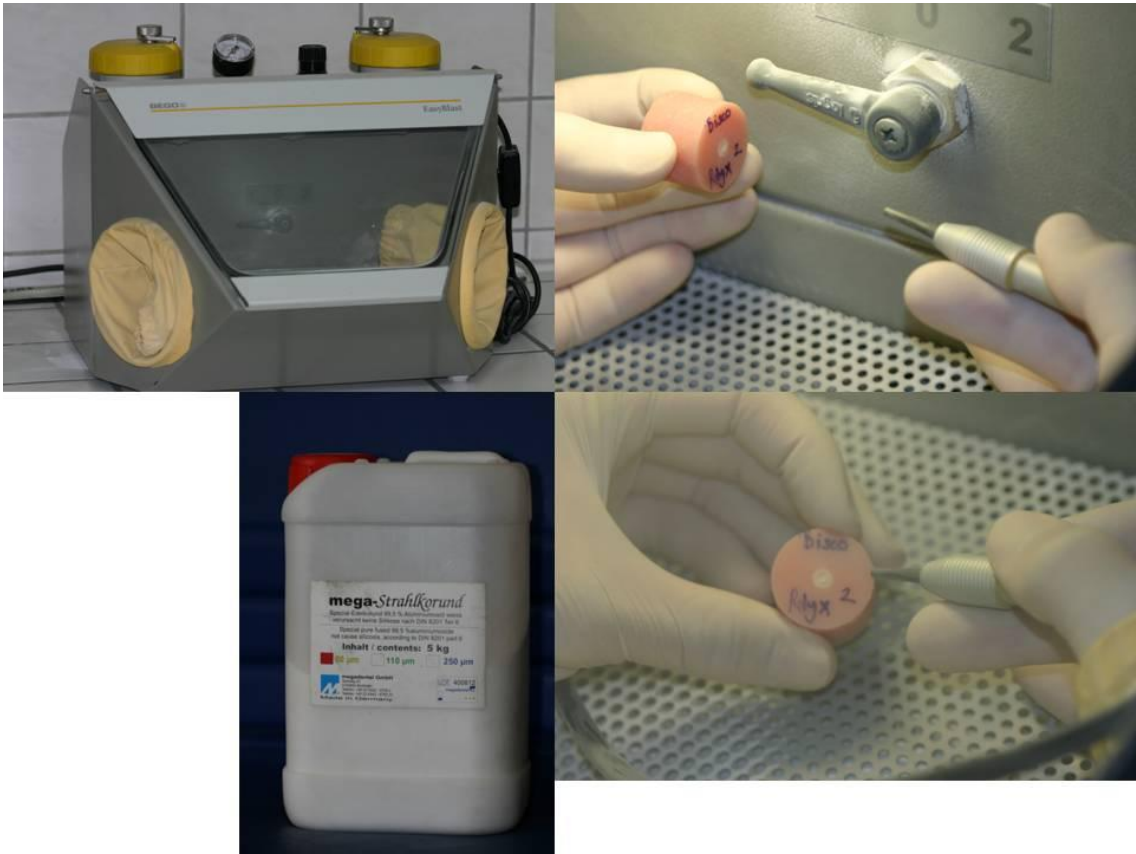
Şekil 3-13: Bego Easyblast kullanarak 50µm'lik alüminyum oksit partikülleri ile yüzey hazırlama
