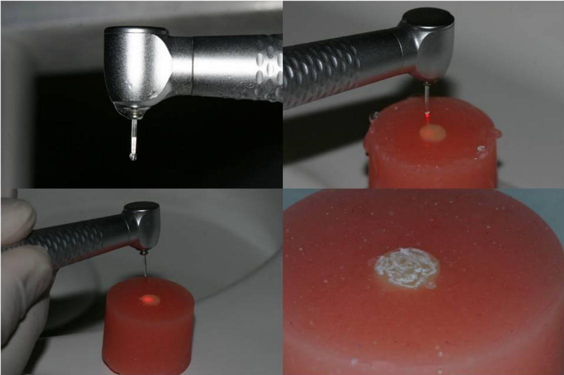
Şekil 3-12: Er,Cr:YSGG lazer kullanarak yüzey hazırlama
