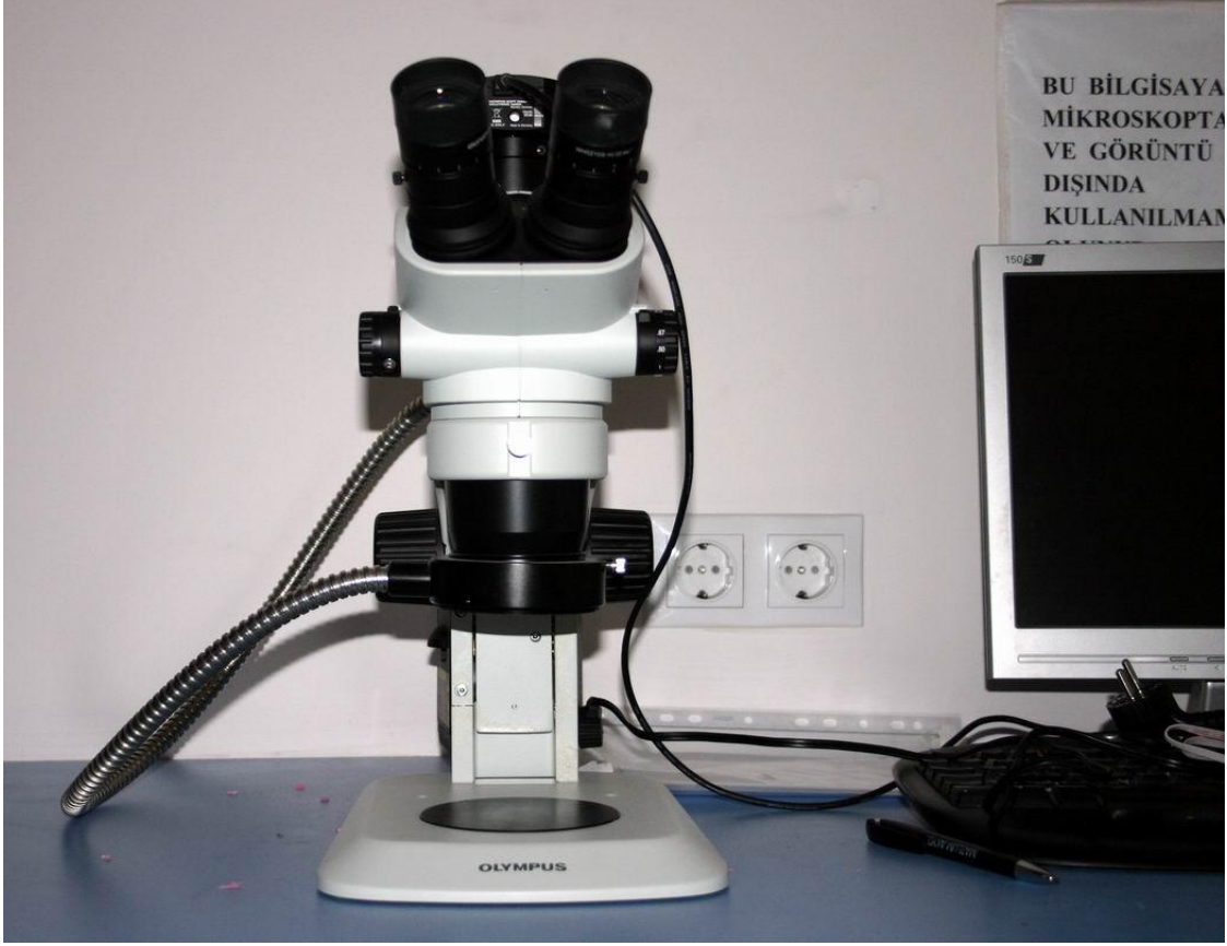
Şekil 3-21: Kopma tiplerinin değerlendirildiği stereomikroskop
