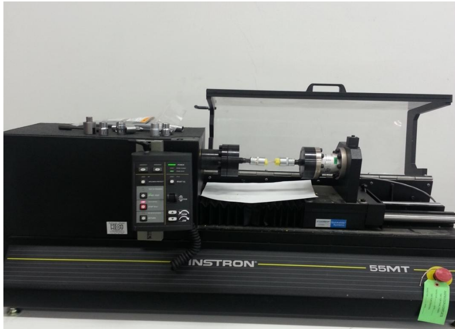
Resim 3.11: Burma işlemi için kullanılan cihaz
