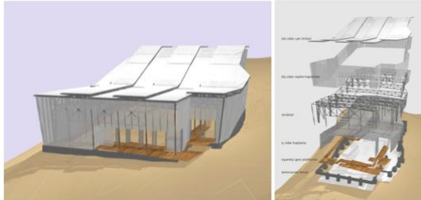
Şekil 3.26: Koruma Yapısı Proje Çizimi Atölye Mimarlık
