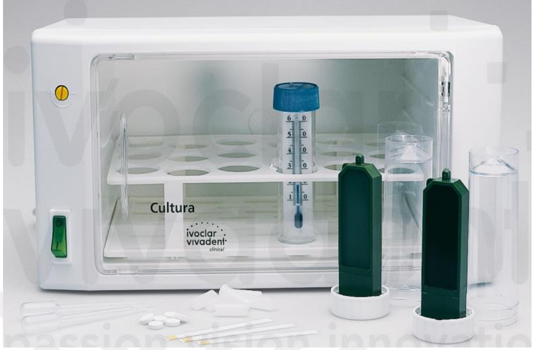
Şekil 2.5: CRT bacteria tüplerinin 37° C’de 48 saat bekletildiği İnkübatör
