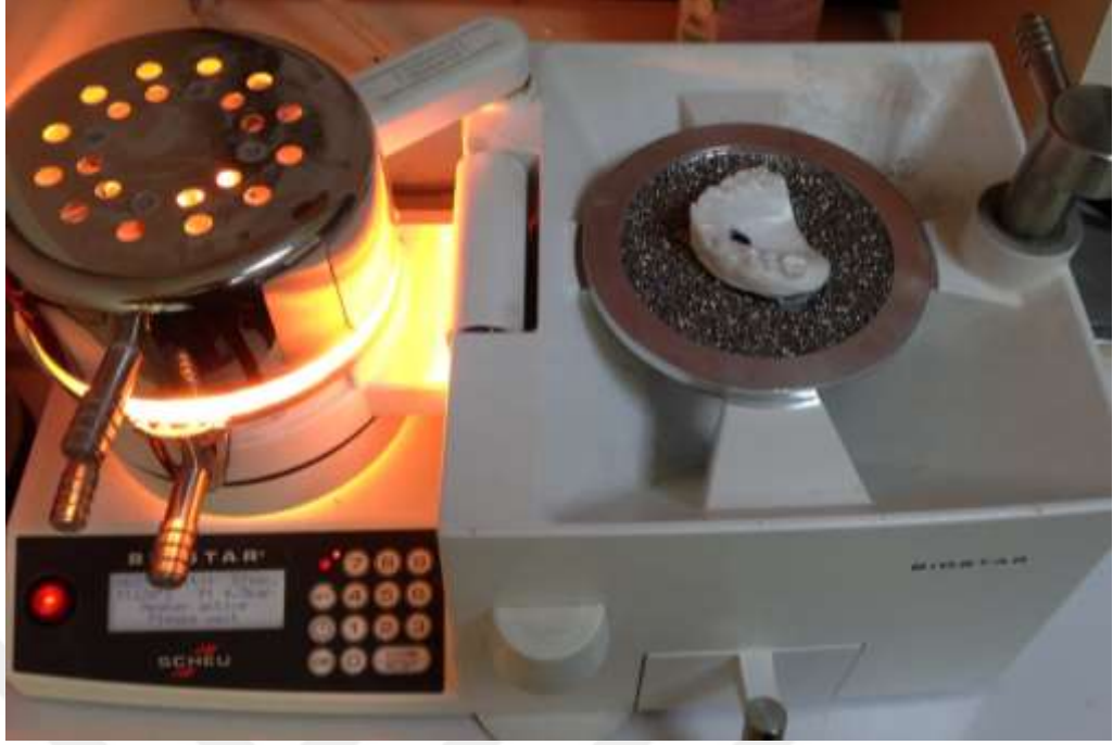
Şekil 2.4 Üst dental modelin Isofolan ile kaplanması ve ekspansiyon vidasının modele adapte edilmesinden sonra Biostar ünitesine yerleştirilmesi ve 64°C sıcaklıkta 90 saniye ısıtılarak 4.3 bar basınç ile modele basılması.
