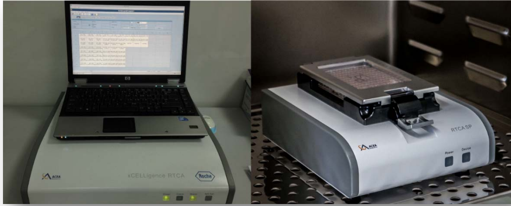
Şekil 2.16 Çalışmamızda kullanılan xCELLigence RTCA sistemi
