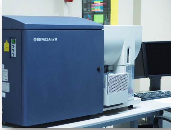
Şekil 2.3 Çalışmada kullanılan akan hücre ölçer
