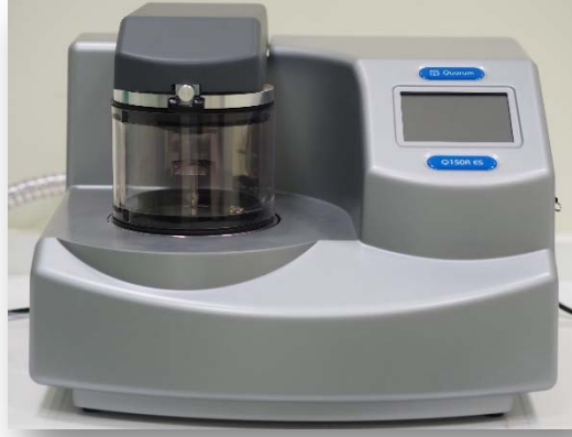
Şekil 2.19 Çalışmada kullanılan altın-palladyum kaplama cihazı
