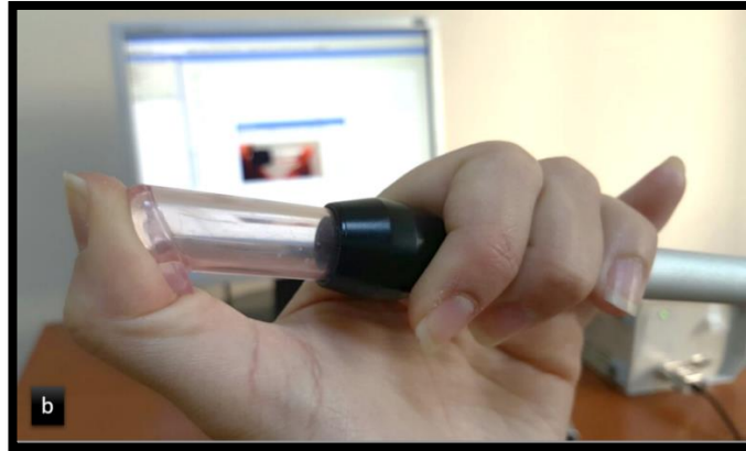
Şekil 2.7. Burun adaptörü ile kalibrasyon. a. Burun adaptörünün yerleştirilmesi gerektiğini gösteren uyarı.b. Burun adaptörünün parmakla kapatılıp kalibrasyon işleminin yapılması.
