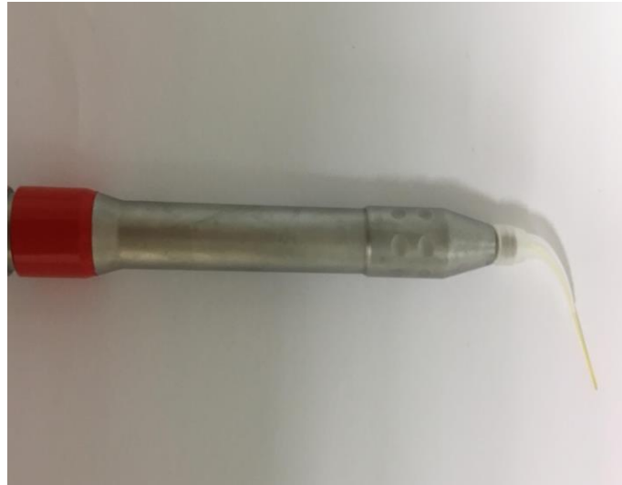
Şekil 2.7 Nd:YAG Lazer'e ait 320 µm'lik fiber optik uç
