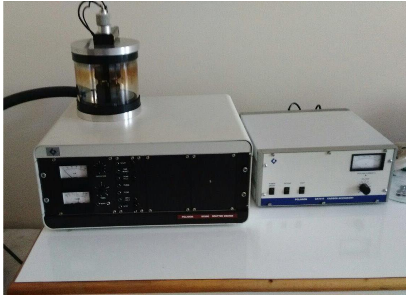
Şekil 2.11 Sputter cihazı (Altın-palladyum kaplama cihazı)
