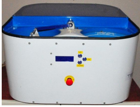
Şekil 2.8: Örneklerin yaşlandırma işleminde kullanılan termal siklus cihazı
