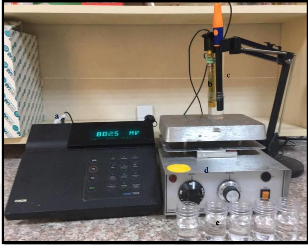
Şekil 2.14: a) Potansiyometre b) Ag/AgCl referans elektrot c) Florür iyonlarına duyarlı florür iyon seçici elektrot d) Magnetik karıştırıcı e) Kalibrasyon çözeltileri
