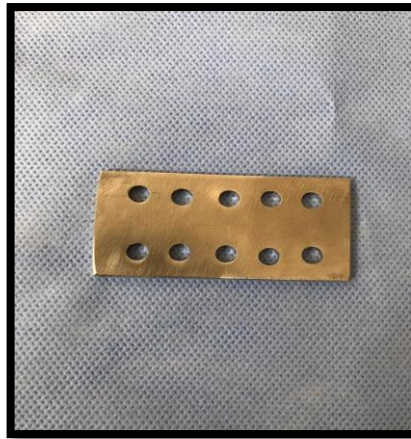
Şekil 2.2: Dolgu materyallerine ait örneklerin hazırlandığı paslanmaz çelik kalıp
