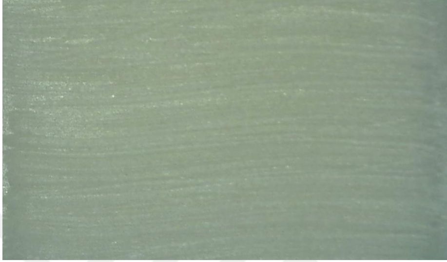
Şekil 3.40: Vita Enamic materyalinin frez ile pürüzlendirme grubunun steromikroskop görüntüsü
