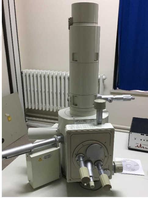
Şekil 2.34: Taramalı Elektron Mikroskobu
