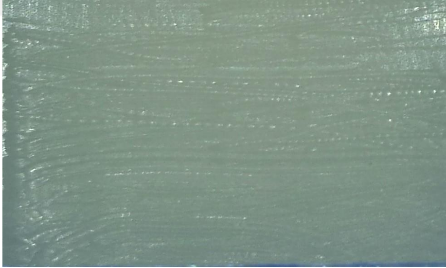
Şekil 3.43: Lava Ultimate materyalinin frez ile pürüzlendirme grubunun steromikroskop görüntüsü
