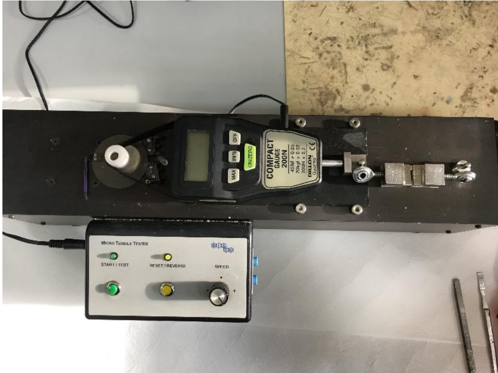
Şekil 2.26: Mikro- Gerilim Dayanım Test Cihazı
