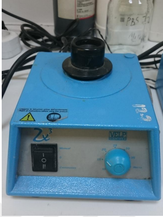
Şekil 2.12. Çalışmada kullanılan vorteks cihazı.
