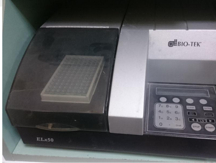
Şekil 2.16. ELİSA BioTek EL×50 otomatik yıkayıcısı.
