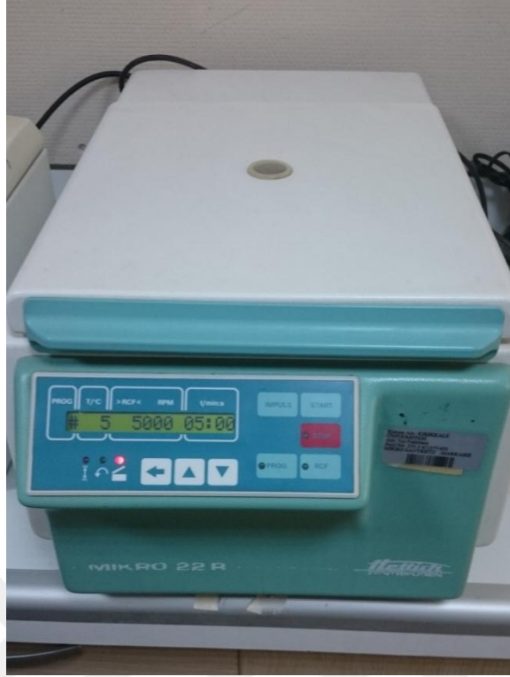
Şekil 2.14. Çalışmada kullanılan Hettich Micro 22R santrifüj cihazı.
