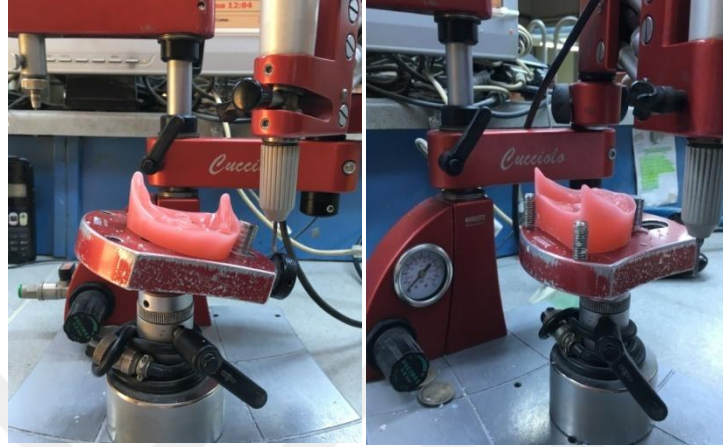
Şekil 2.3: Paralelometre yardımıyla analogların mum modele açılı ve paralel olarak yerleştirilmesi
