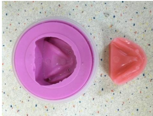
Şekil 2.2: Örnek modelden mum duplikatların elde edilmesi
