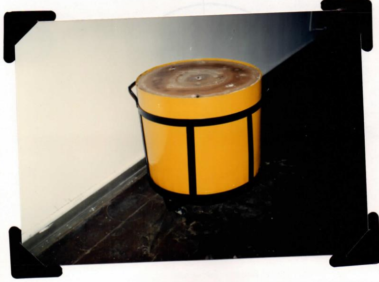
FOTOĞRAF-III.1.1 Ra-Be nötron kaynağının yandan görünüşü.
