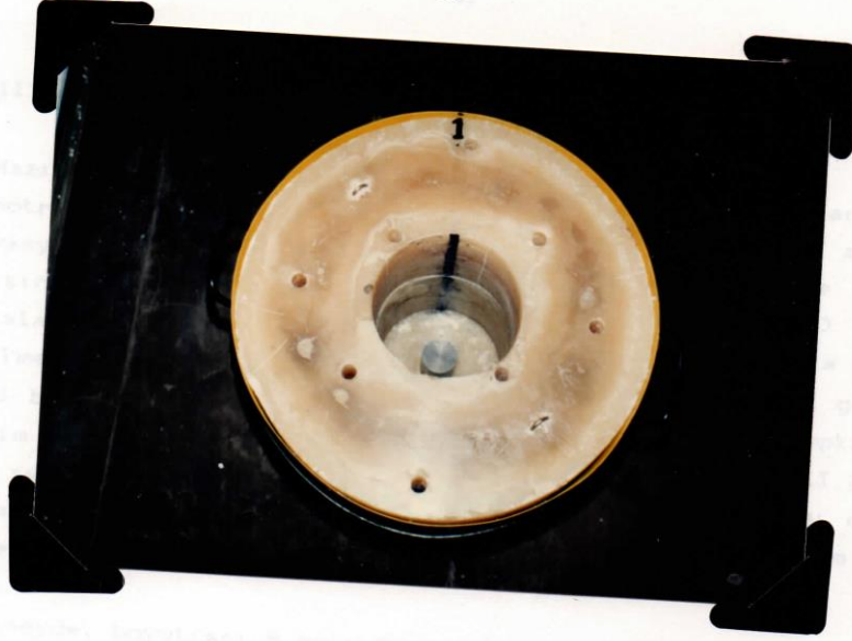
FOTOĞRAF-III.1.5 : Kaynağın dış parafin bloklarının yerleş- tirilmiş hali
