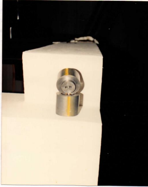
FOTOĞRAF-III.1.4 : Ra-Be çubuklarının bulunduğu kurşun zırhın görünüşü.
