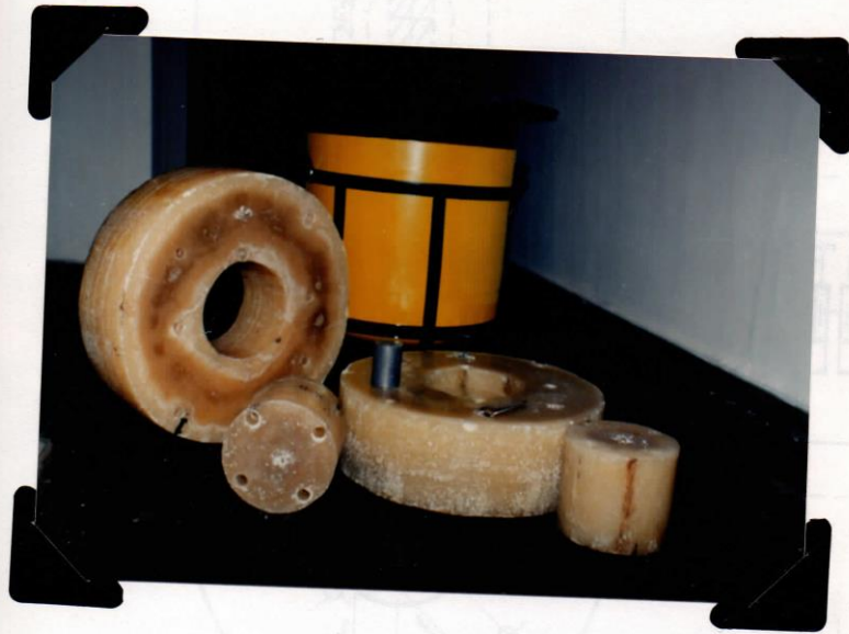
FOTOĞRAF-III.1.2 : Yavaşlatıcı olarak kullanılan parafin blokların ayrı ayrı görünüşü.
