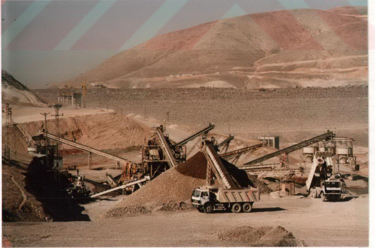
Foto 8 Nehir Alüvyonunun Elenerek Filtre Malzemesi Olarak Hazırlanışı.
