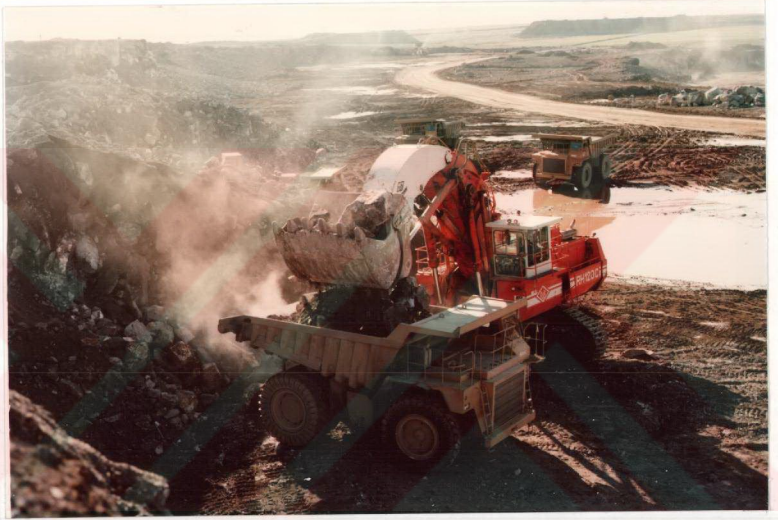
Foto 6 Bazalt Ocağından Yapılan Yükleme(Yükleyici RH 120C 15 m3, Kamyon 85 tonluk.)
