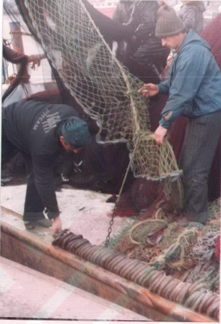
Resim 14: Mapaların, kurşun yakanın ve ağın güvertede istifini.
