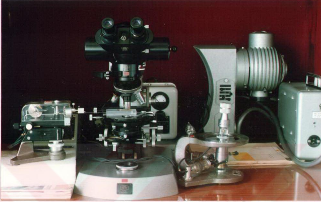
Şekil 1- Fonbrune tipi bir mikromanipülâtör.
