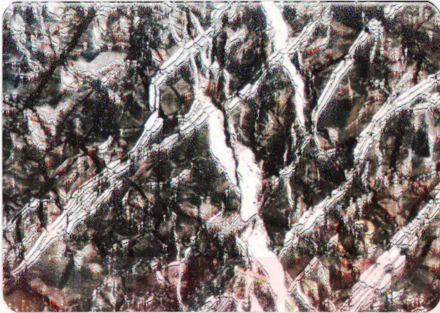
Resim 19. Serpantinitte birbirine paralel ve düzensiz olarak gelişmiş krizotil damarları. Karaziyaret Tepe (K.Maras).
