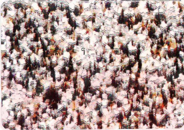
Resim 2. Kuvars sist/kuvarsit'te kuvars(q,beyaz renkli) taneleri arasında bulunan mika (m, sarı renkli) ve demiroksit (koyu renkli) mineraleri. Deliköleli obası (K.Maras).
