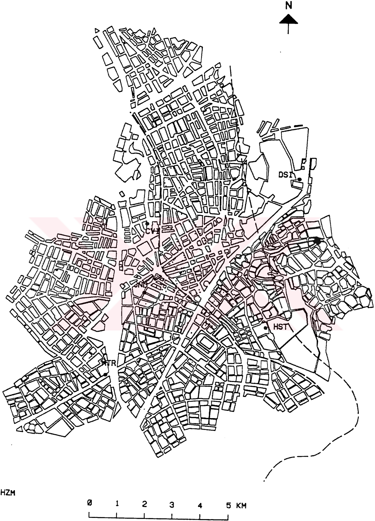
Şekil 3.2: İvme kayıtçılarının Dinar ilçesinde konumlandırıldıkları yerler. MTR; Afet İşleri'ne ait istasyonu, KÖY HZM, JND, CVI, HST, DSI: çalışmada kullanılan istasyonları göstermekte; (---) kesik çizgiler Dinar'da görülen üç ayrı jeolojiyi ayırmaktadır.
