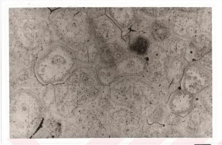
Şekil 3.2: Etial 24 alaşımının 2 (a, b) , 4 (c,d) ve 8 (e, f) saat süreyle çözeltiye alma işleminden sonra elde edilen mikroyapılar.
