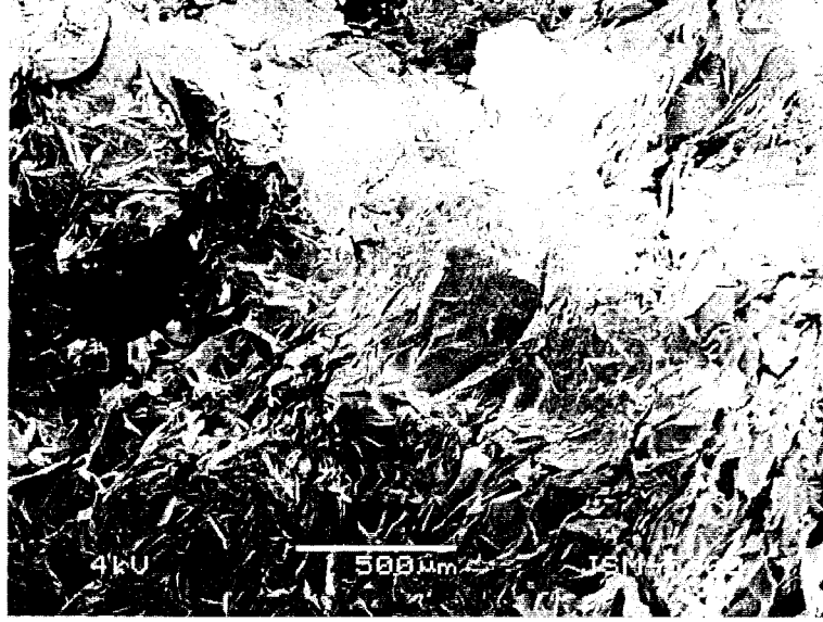
Şekil III. 60. pNIPAm/1NMBA polimerinin 50X büyütme ile çekilmiş SEM görüntüsü.
