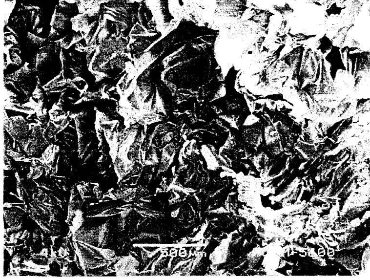
Şekil III. 70. p(NIPAm/3NaAMPS)1.25NMBA kopolimerinin 50X büyütme ile çekilmiş SEM görüntüsü.
