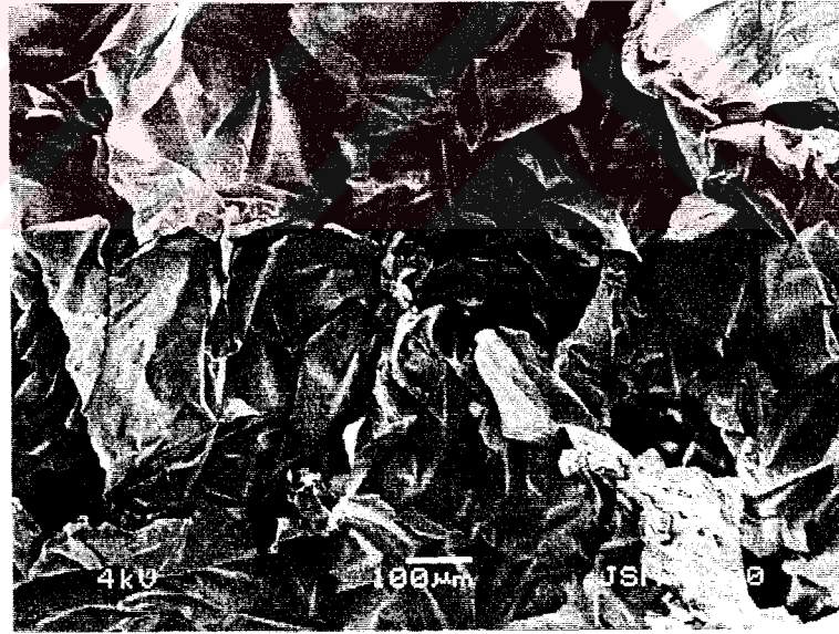
Şekil III. 71. p(NIPAm/3NaAMPS)1.25NMBA kopolimerinin 100X büyütme ile çekilmiş SEM görüntüsü.
