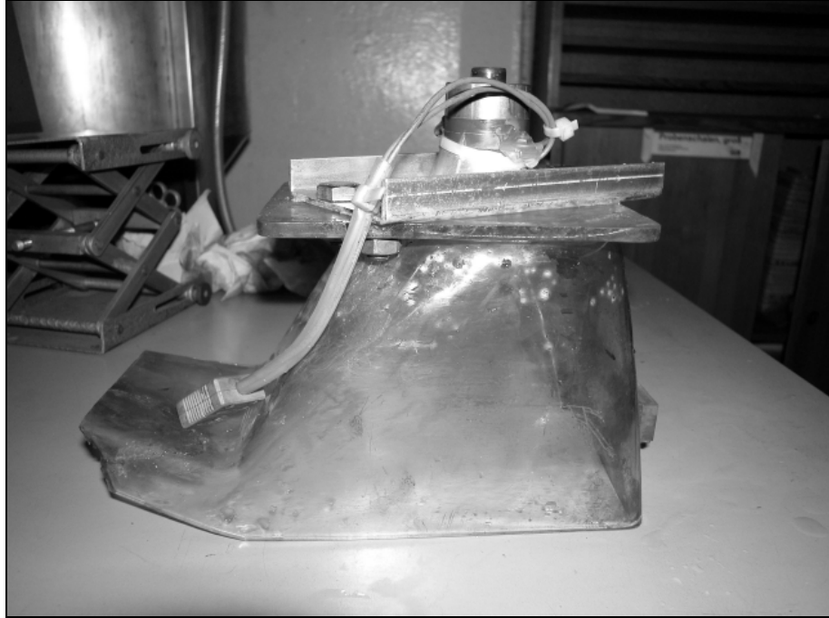
Şekil 3.4.b: Kullanılan transduserin selüle monte edilmiş hali
