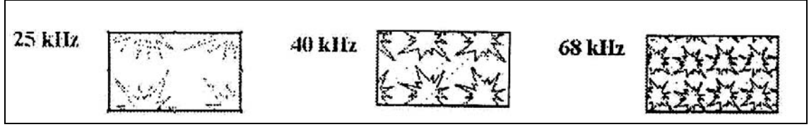
Şekil 2.19: Çeşitli frekanslarda kavitasyon oluşumu [1].
