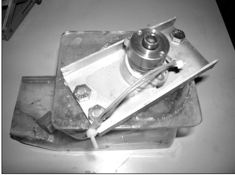
Şekil 3.4.a: Kullanılan transduserin selüle monte edilmiş hali
