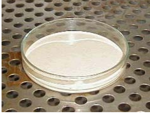
Şekil 3.17: Tutkal testinde erimenin tamamlanması
