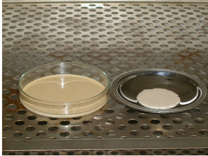
Şekil 3.18: Tutkal testinde renk koyulaşması
