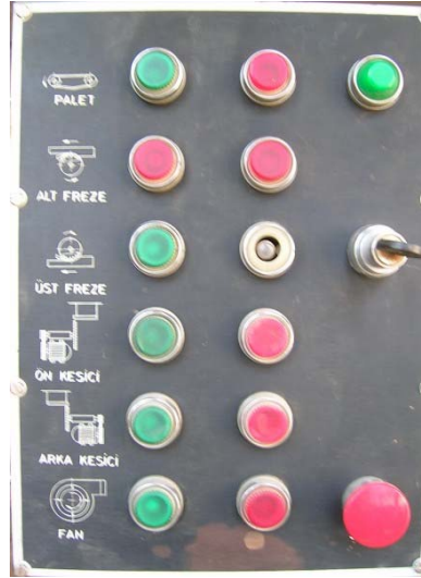
Şekil 3.7: Uygulamada kullanılan kenar bantlama makinesinin kontrol paneli
