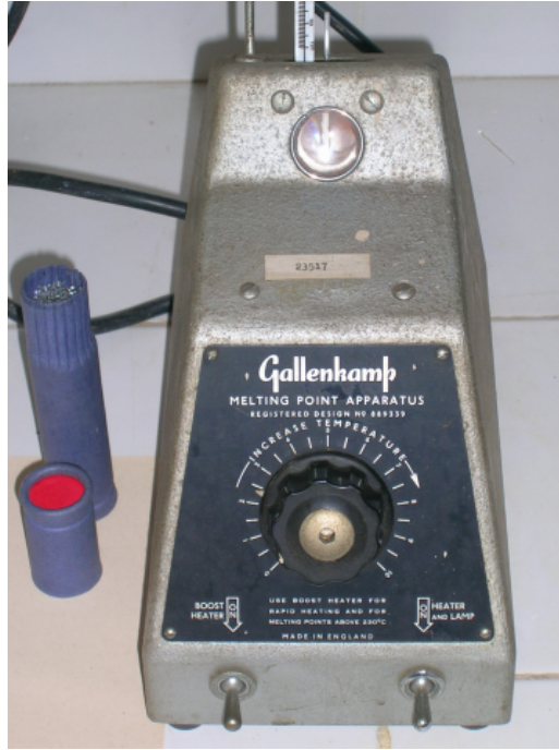
Şekil 3.20: Gallenkamp marka İngiltere yapımı erime noktası tespit cihazı
