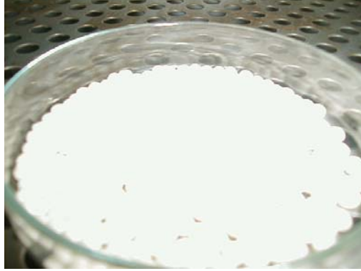
Şekil 3.15: Tutkal testinde yumuşama başlangıcı
