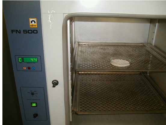
Şekil 3.14: Sıcak eritim tutkalın etüve yerleştirilmesi
