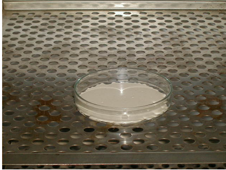
Şekil 3.16: Tutkal testinde erime başlangıcı
