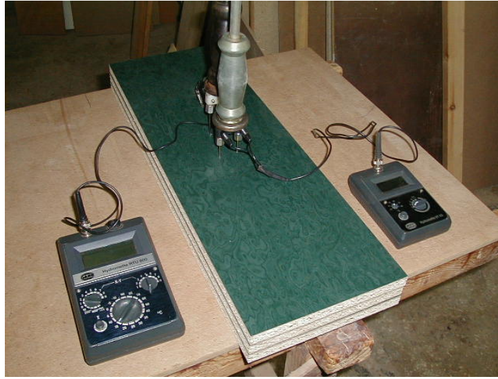
Şekil 3.12: Yongalevha rutubetlerinin ölçülmesi
