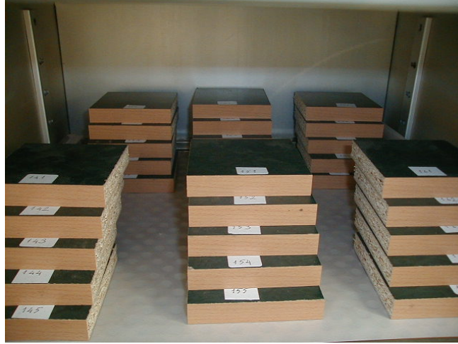
řekil 3.24: Kenarı kaplanmış levhaların sıcaklıđa dayanımının test edilmesi
