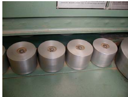
Şekil 2.26: Altı silindirik baskı merdaneleri (Düz kenarlar için)
