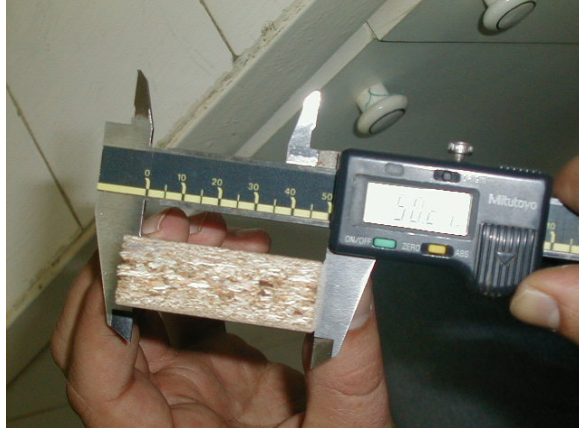
Şekil 3.10: Özgül ağırlık tayini için yongalevha örneklerinin kenar uzunlukları ölçümü
