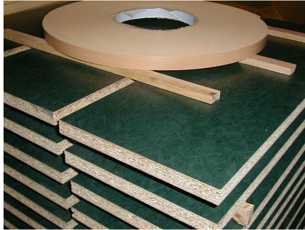
Şekil 3.13: Kenar bandının klimatize edilmesi
