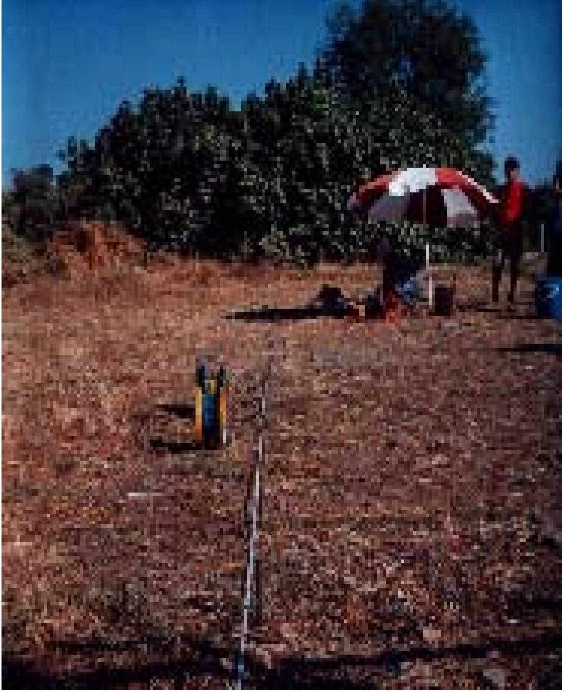
Fotoğraf 4.5. Palaestra alanında yapılan Jeofizik Özdirenç Ölçülerindeki Elektrot Düzeni.
