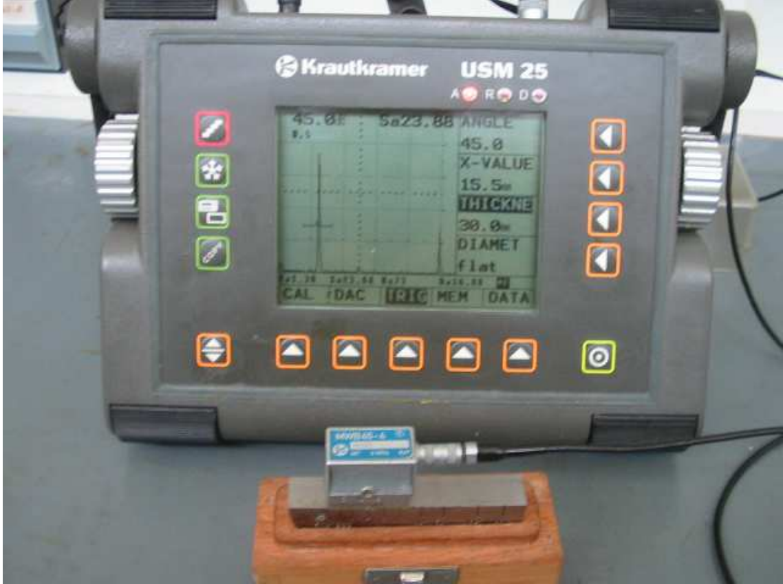
Şekil 3.15: IIW V2 kalibrasyon bloğu ve cihazın ekran görüntüsü
