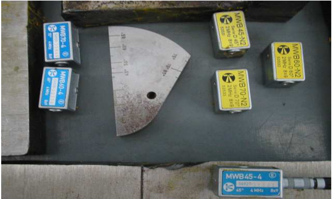
Şekil 3.11: Deneysel çalışmada kullanılan problar (MWB 45-2, MWB 60-2, MWB 70-2, MWB 45-4, MWB 60-4, MWB 70-4)
