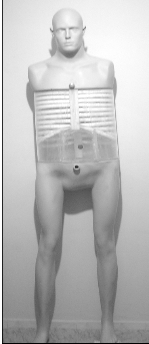
Şekil 3.2.: İnsan vücut fantomu (Doldurulabilir Tüm Vücut PET Fantomu). Fantom 100 Kg ağırlıklı erkek bir hastayı taklit edecek şekilde oluşturuldu. Fantom Üç ana bağımsız parçadan oluşmaktadır (Omuz-Baş, Akciğer-Göğüs Kafesi ve Pelvis-Alt Ekstremitte Bölümleri). Her bölüm içine su ve [ ^{18}\text{F} ]-FDG doldurulabilecek şekilde tasarlandı.
