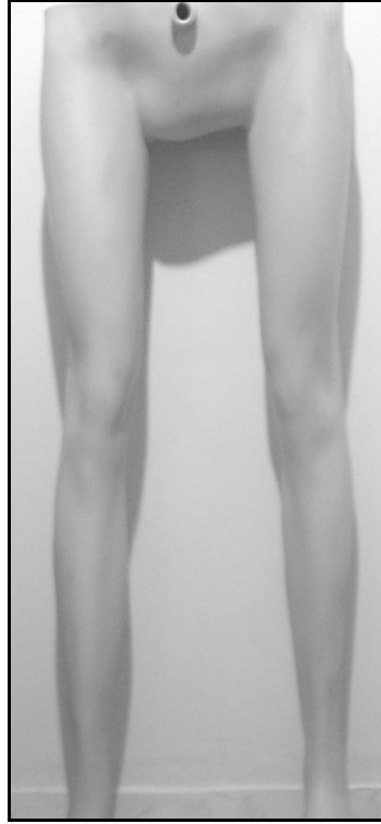
Şekil 3.5.: İnsan vücut fantomunun pelvis-alt extremiteler bölümü. Bu bölüm 45 lt su alacak şekilde tasarlandı. Mesaneyi temsil etmesi amacıyla 0.5 lt hacimli bağımsız bölüm oluşturuldu.
