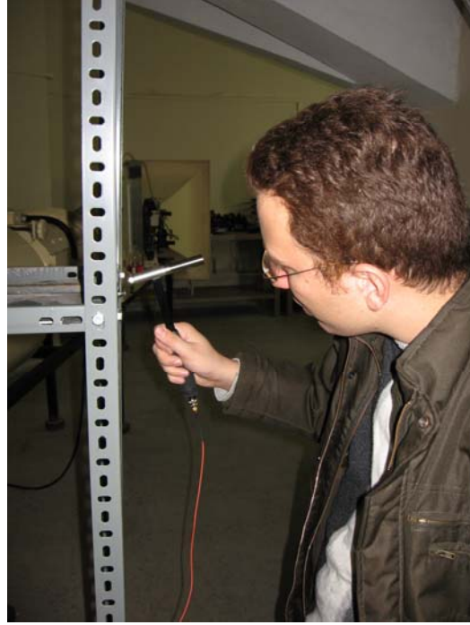
Şekil 3.11: Kata darbe çekiciyle vurularak titreşim başlatılması
