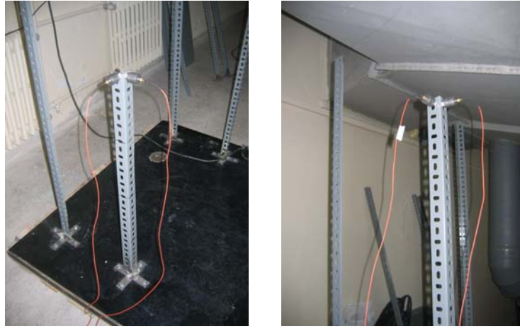
Şekil 3.6: İvmeölçerin farklı yüksekliklerde bağlanması
