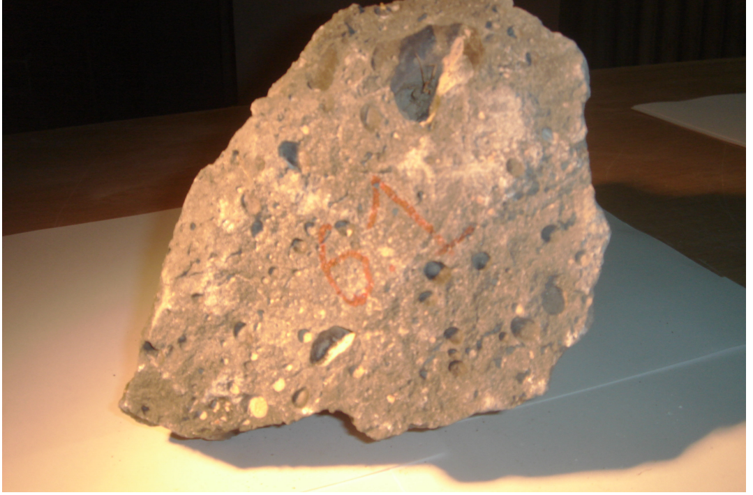
Şekil 5.12: Altıncı Mevkiden alınan gözenekli bazalt numunesi.
