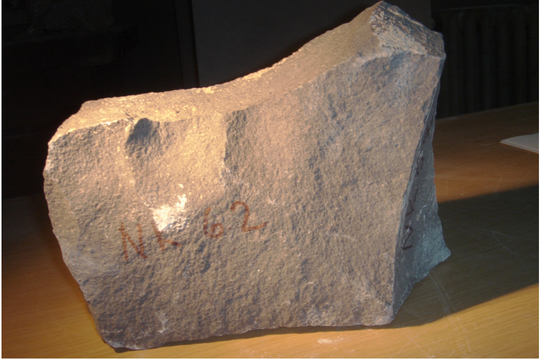
Şekil 5.13: Altıncı Mevkiden alınan bazalt numunesi.
