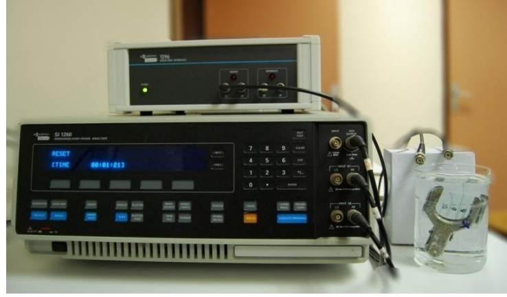
Şekil 3.6: Proton İletkenlik Ölçüm Sistemi
