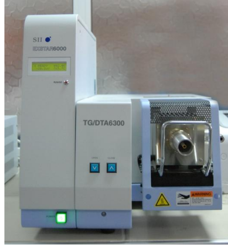
Şekil 3.10: Termal analizlerin gerçekleştirildiği TG/DTA sistemi
