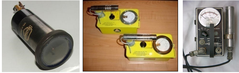
Şekil 2.13: Geiger-Müller Tüplü Dozimetreler
