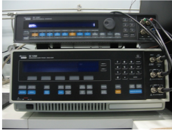
Şekil 3.6: Elektrokimyasal empedans spektroskopisi ölçüm sistemi
