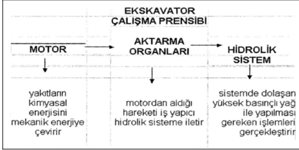
Şekil 2.19: Ekskavatör çalışma prensibi
