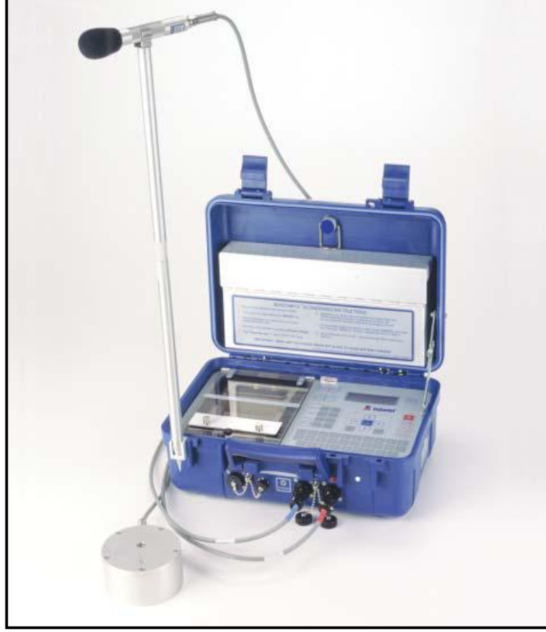
Şekil 3.3 Instantel Blastmate III model titreşim ve hava şoku izleme cihazı
