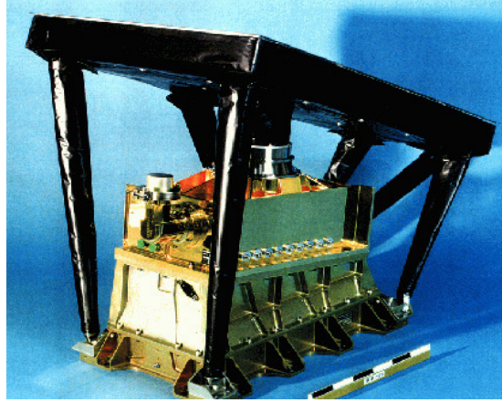
Şekil 3.21: Soğutucusuyla birlikte RGS spektrometresi (MSSL 1999f, XMM-Newton instruments). Işıklar alt taraftan girer.
