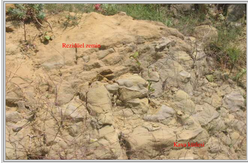
Şekil 4.2 İnceleme alanında yer alan kaya kütlelerinde belirlenen bozunma profili
