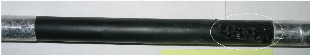
Şekil 4.44: Titreşim etkisi altında test örneğinde oluşan bozulma
