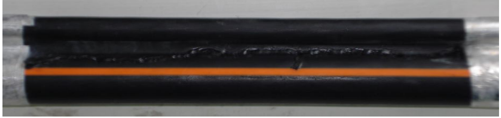
Şekil 4.12: Askı halatlı F/O kablonun deney sonrası görünümü
