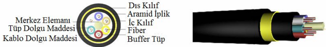
Şekil 2.2: ADSS kablo yapısı ve kesit görüntüsü
