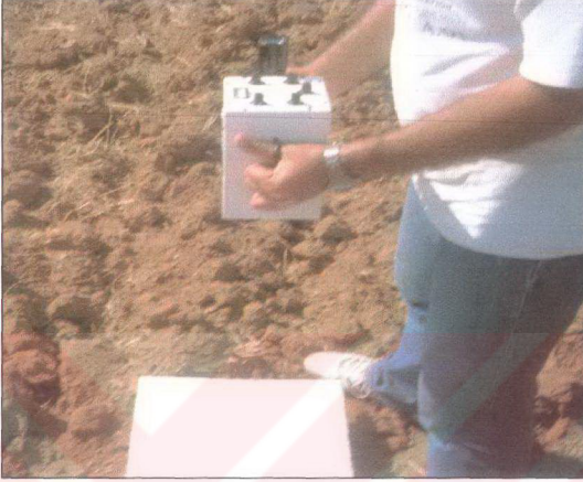
Şekil. 3.7. Spektrodymetrenin baryum sülfat ile kalibrasyonu
