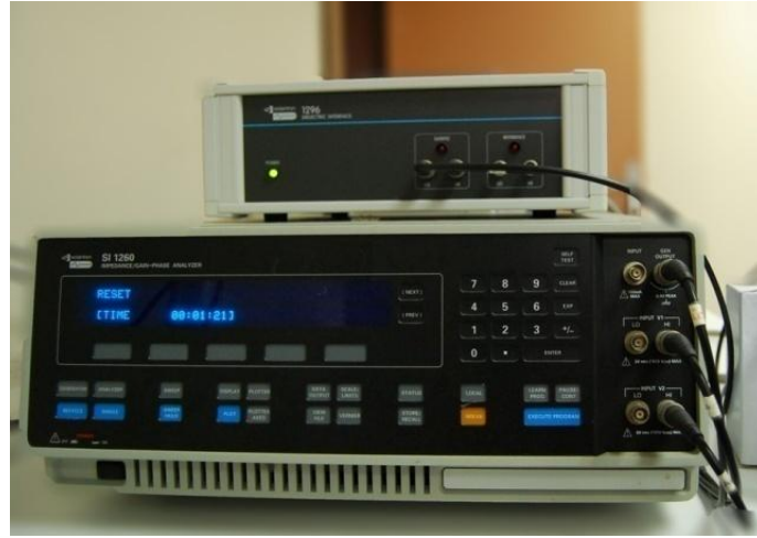
Şekil 3.18 Elektrokimyasal empedans ölçümlerinin gerçekleştirildiği EIS cihazı
