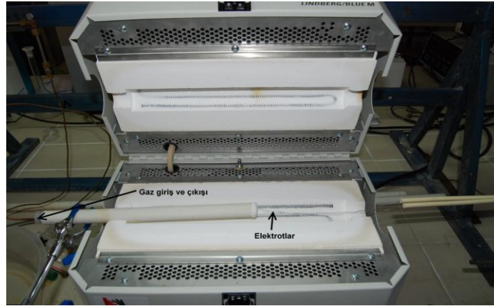
Şekil 3.14 Hazırlanan tek hücre ve kontrollü sıcaklık fırınına ait görünüm
