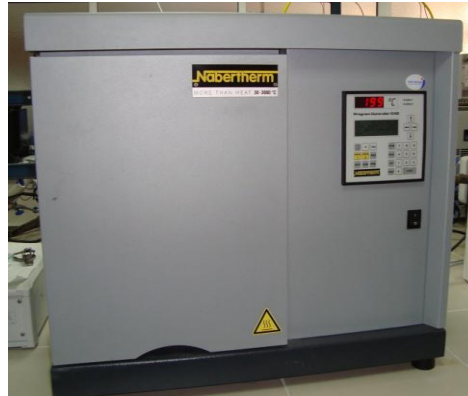
Şekil 3.8 Bağlayıcı yakma ve sinterleme işlemlerinin yapıldığı sıcaklık kontrollü sinterleme fırını
