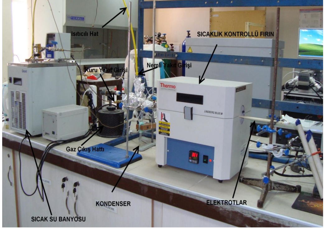
Şekil 3.16 Katı oksit yakıt hücresi ünitesi test düzeneği
