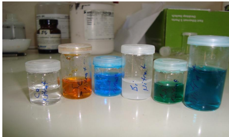
Şekil 3.9 Gözenekli anot yapılarına emdirilen katalizör çözeltileri
