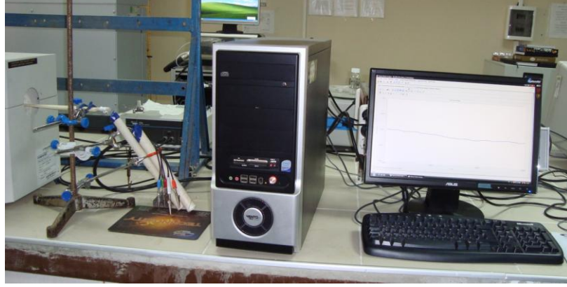
Şekil 3.20 Akım-Voltaj ölçümlerinin gerçekleştirildiği potansiyostat cihazı
