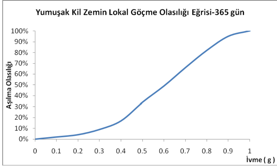
Şekil 4.51 Yumuşak Kil Zemin Göçme Olasılık eğrisi
