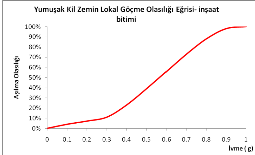
Şekil 4.94 M Noktası Lokal Göçme Olasılığı Eğrisi
