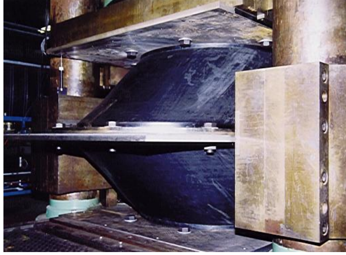
Şekil 2.5: UC Berkeley - Hearst Memorial Mining Building Binası için kullanılan kauçuk mesnetlerin prototip deneyi (Fotoğraf: Seismic Isolation Engineering-SIE Inc.)
