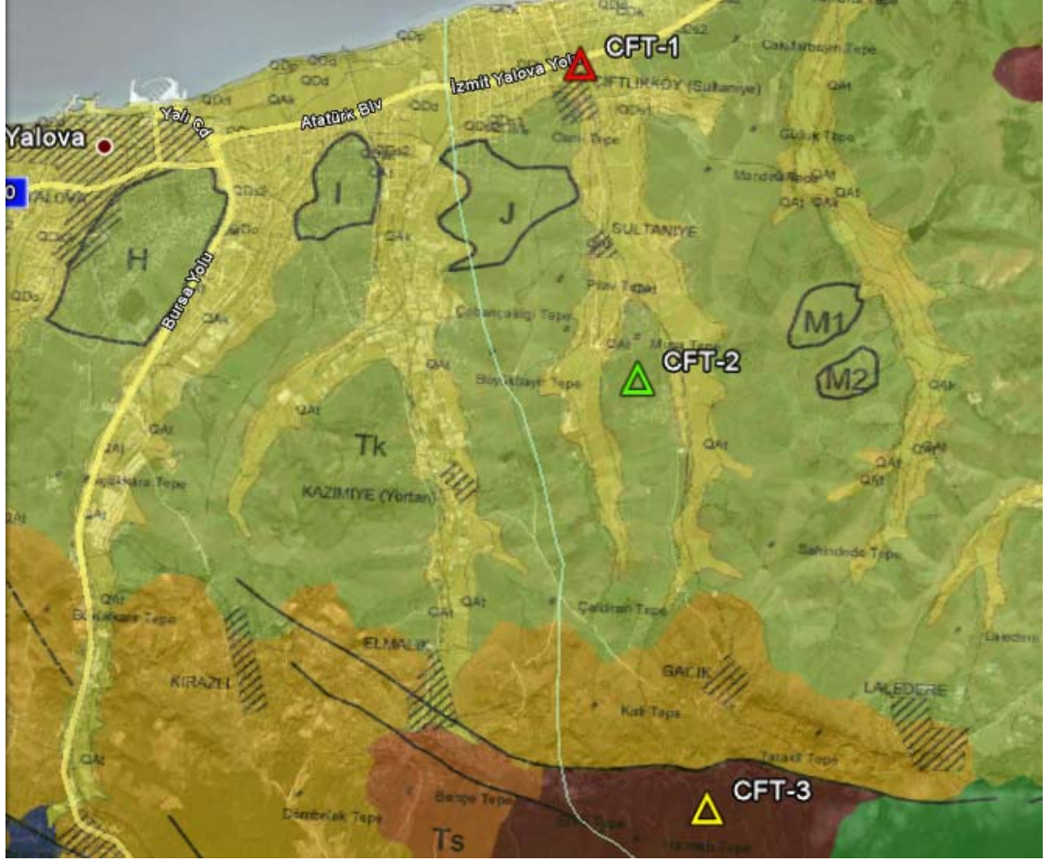
Şekil3.37: Yalova Çiftlikköy ilçesi için seçilen simülasyon noktaları (kırmızı üçgen, gevşek zemin; yeşil üçgen, sıkı zemin ve sarı üçgen, kaya olan noktaları göstermektedir)
