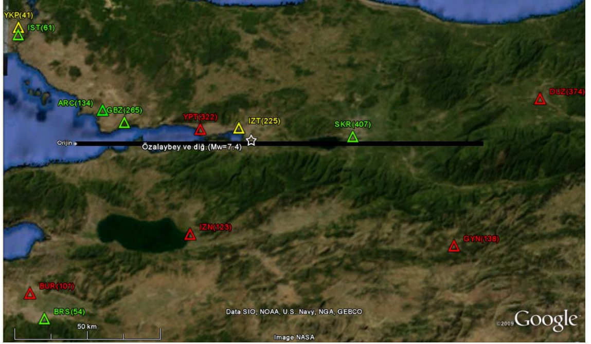
Şekil 3.19: Belirlenen fay modeli ve ivme ölçer istasyonları (sarılar kaya, yeşiller sıkı zemin ve kırmızılar zemin üzerindeki istasyonları göstermektedir. Parantez içindeki sayılar istasyonlarda ölçülen en yüksek ivme değerlerini belirtmektedir)
