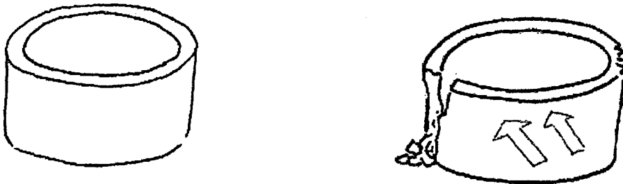
Şekil 7.3. Daire Biçimli Yapıda Oluşabilecek Hasar (Zacek, 2002a)
