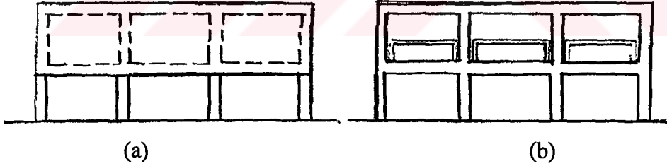
Şekil 7.41. Farklı Kat Rijitliklerinin Benzerleştirilmesi
