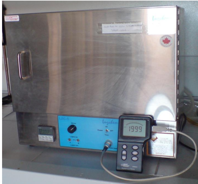
Şekil 3.2: Fotokatalitik reaksiyonlarda kullanılan fotoreaktörün reaksiyon esnasında dış görünümü
