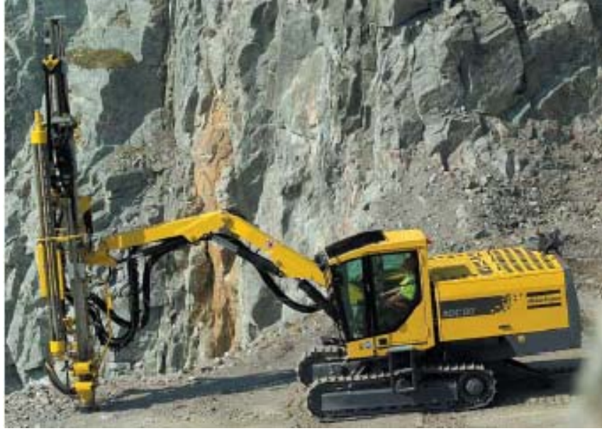
Foto 4.8 : Cendere bölgesinde kullanılan Atlas Copco marka delici makina.
